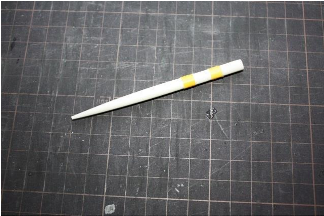
画像 1 2 : 完全乾燥した状態、糸で仮巻きする必要があるほど、完全に形ができている。 この段階で、接着はしない。
