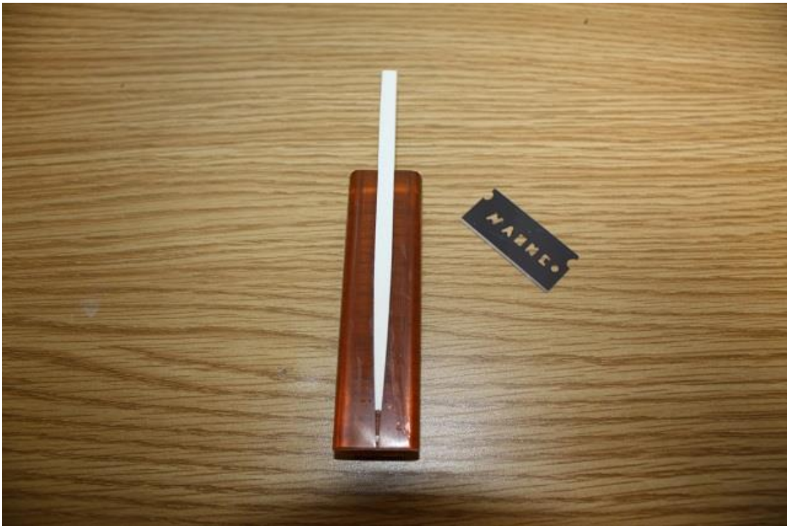
画像5：羽根の2枚合わせを製作する際に羽根の脚側の成形
