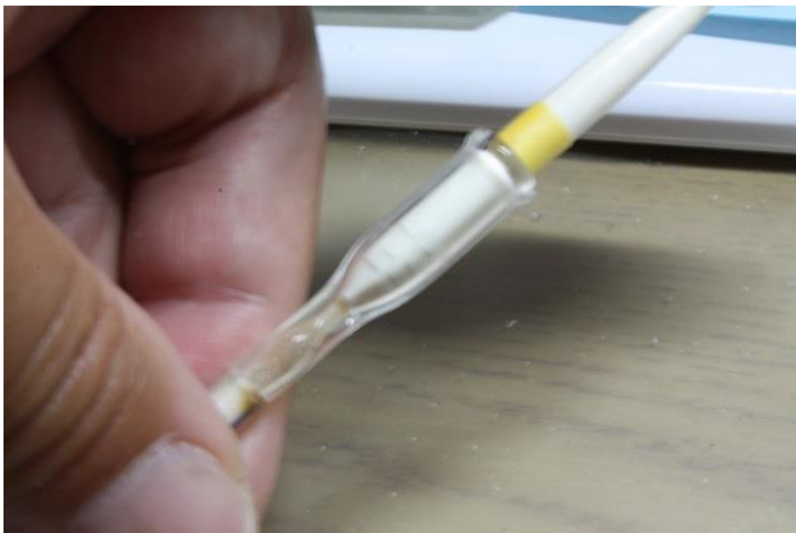
画像13： ガラス管に差し込みながら、隙間が空かないよう、所定の寸法に到達するように、紙ヤスリで削っていく。
