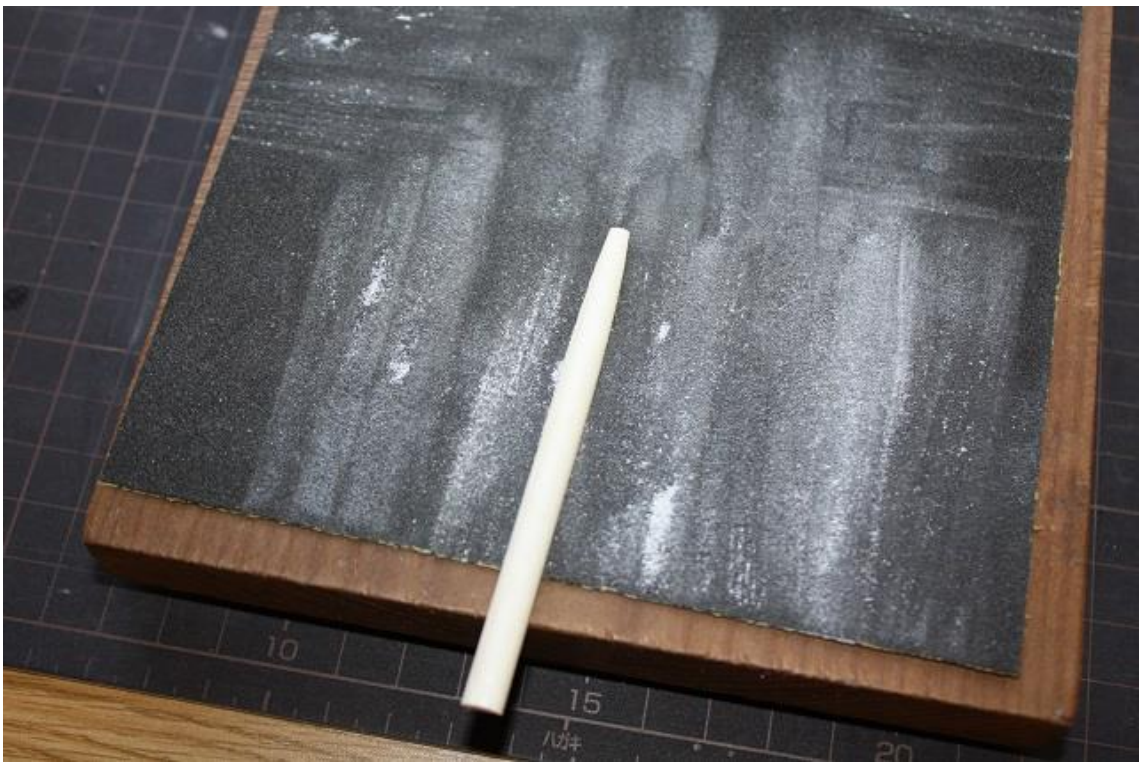
画像8： 紙ヤスリで微調整し、絞り成型器の所定の寸法まで、入るようにする。
