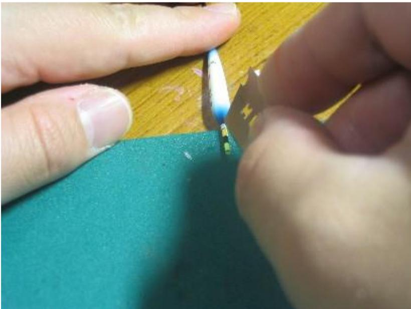
キャプション：今度は、トップの縦方向から、カミソリの刃をいれていきます。最初は4つ割り、さらには8つ割りにして、ソリッドアダプタを傷つけないように、慎重にトップを剥がしていきます。
